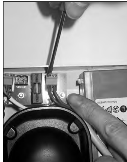
Figura 9a : Ligação do bus da central Figure 9b : Ligação da alimentação
