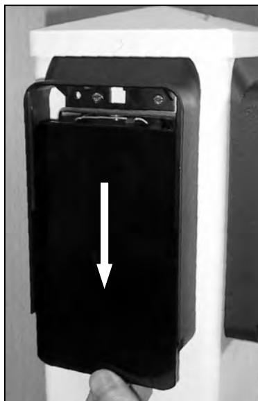
Figura 6 : desmontagem das protecções
